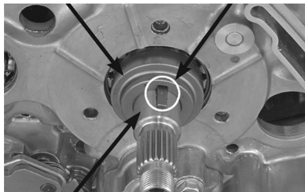
CHAVETA MEIA-LUA ENGRENAGEM MOTORA PRIMÁRIA
