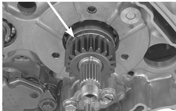
ENGRENAGEM MOTORA PRIMÁRIA
