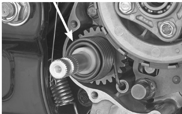
ANEL ELÁSTICO MOLA DE RETORNO
