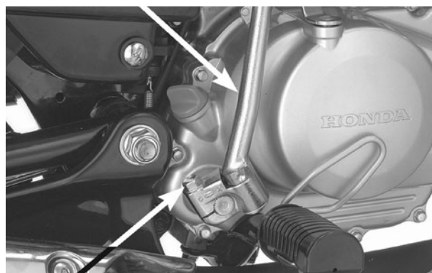
PARAFUSO DE FIXAÇÃO BRAÇO DE ACIONAMENTO SUPORTE DO CABO CABO DA EMBREAGEM
